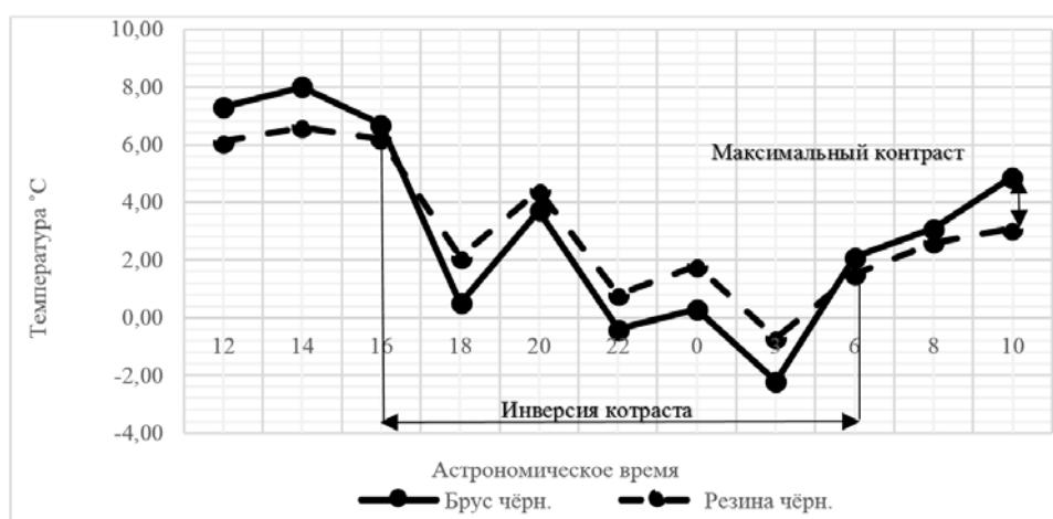
**Рис. 6. Графики изменения радиационных температур для двух разнородных материалов – деревянный брус, окрашенный в черный цвет и резина.**
