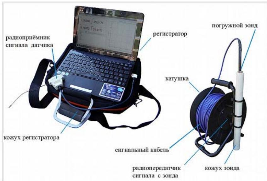
**Рис. 1. Комплектация термометра.**
