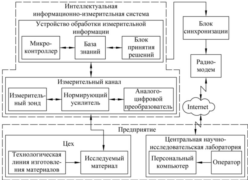
**Рис. 1. Структурная схема ИИИС дистанционного контроля ТФС материалов**
