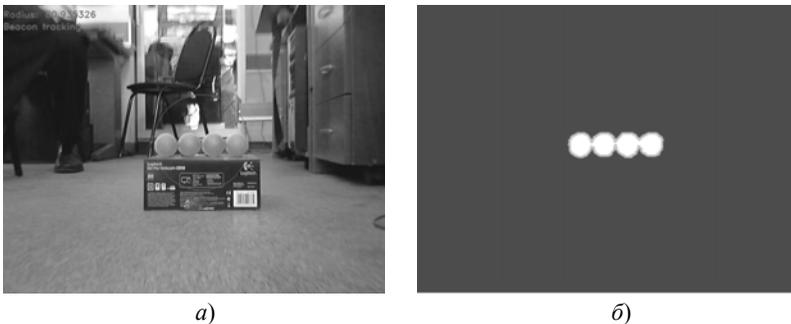
**Рис. 1. Обработанный кадр с видеокамеры (а) и соответствующий отфильтрованный по оранжевому цвету кадр (б)**
